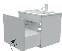
Justering av gångjärn / Justering av hengsler / Adjustment of hinges
